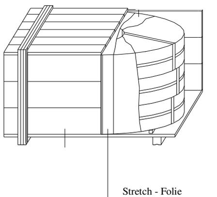
**Bei der Verpackung von Ringstapeln ist die Bodenleiste (50mm) und die Anzahl der Zwischenhölzer von der maximal möglichen Ringbreite abzuziehen!!!**
